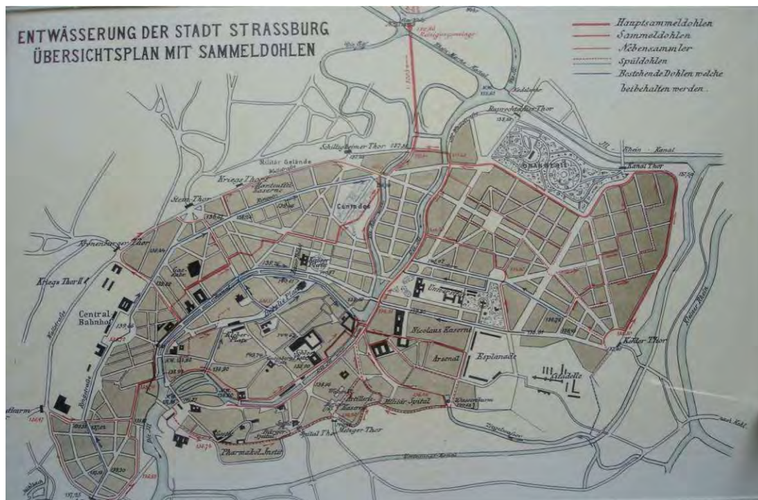
Strasbourg, le réseau des égouts en 1912. (Archives de la Ville et de la Communauté urbaine de Strasbourg).
